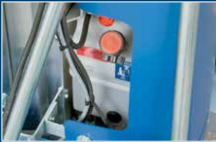
6 1,5 kw power unit
